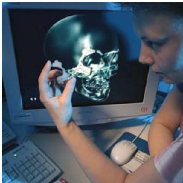
*durch rapid prototyping erzeugtes Kopfimplantat (Abb.5)*
